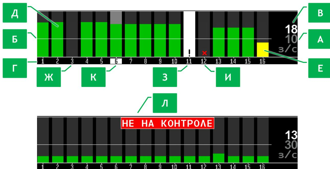
*Рисунок 11 Диаграмма контроля высева в режиме контроля «Поток»*
